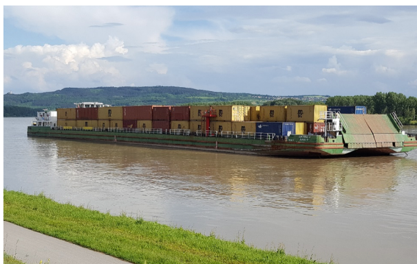
Obr.2: Motorová nákladní loď typu „Chan“ s nákladem kontejnerů na Dunaji. Při ložení do tří vrstev přepraví 150 kontejnerů 40' na LNG (300 TEU)
