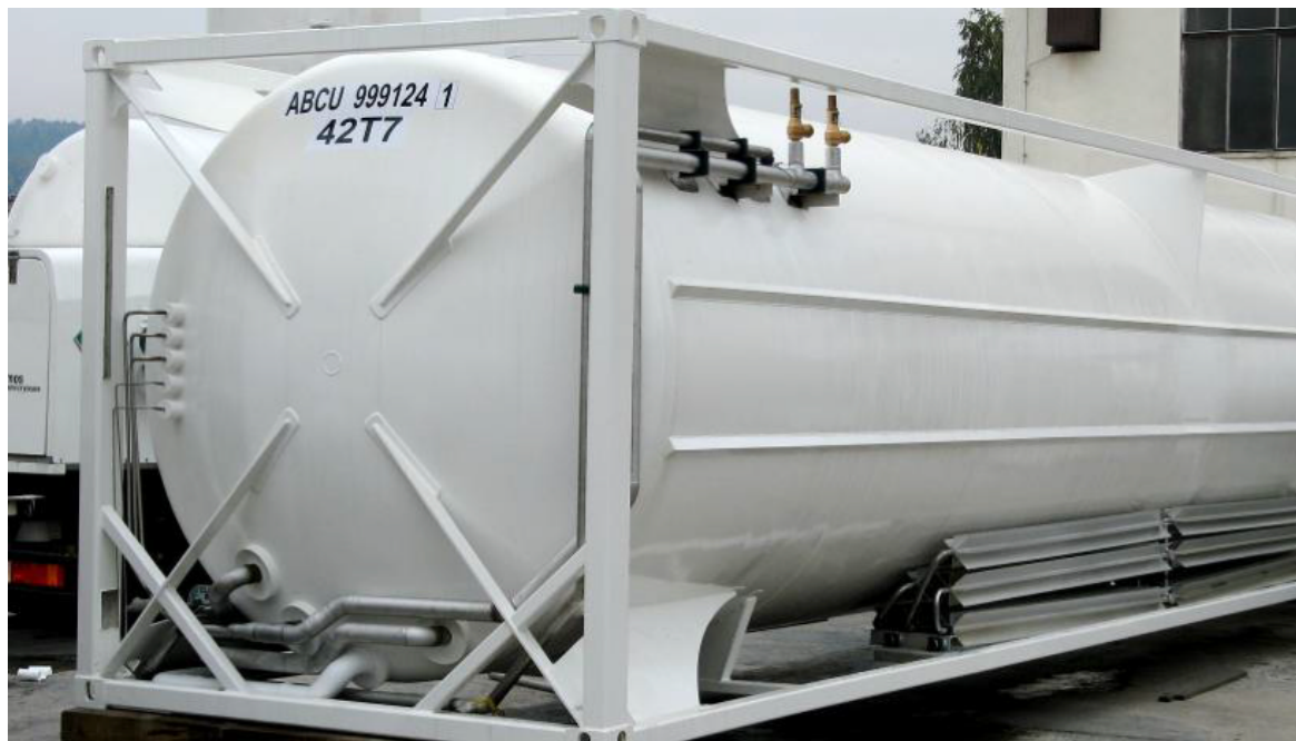
Obr. 1: Standardní kontejner na LNG délky 40 stop
