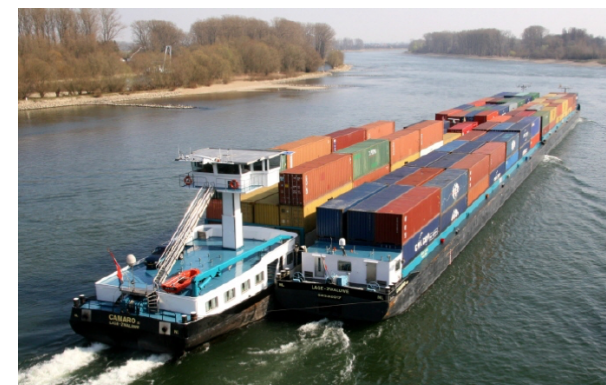
Obr. 4: Motorová nákladní loď a 3 tlačné čluny na horním Rýně. Tato souprava s kapacitou až 600 TEU (300 kontejnerů 40' na LNG) je vhodná pro Dunaj.
