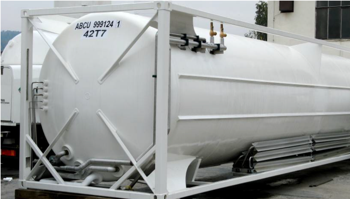
Fig. 1: Standard LNG container of 40 ft length
